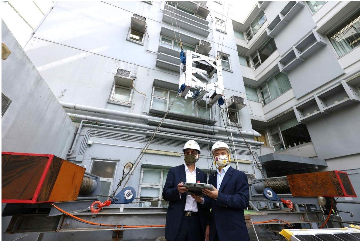
由俊和與中大工程學院研究團隊合作研發的「外牆高空工作線控機械人」，為本港目前首個可模仿工人於外牆以雨刮抹窗，及控制滾筒塗漆的機械系統。去年11月16日，俊和建築控股主席李家粦測量師接受各大傳媒的訪問時表示，期望研究項目除了助解決勞動力不足問題外，更能減低前線工人在高空工作的風險，達致「工地零意外」的目標。
