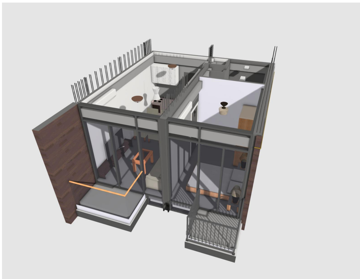
以俊和及巴馬丹拿研發的混凝土 MiC 建成之「五面模組兩房單位」BIM 模型
